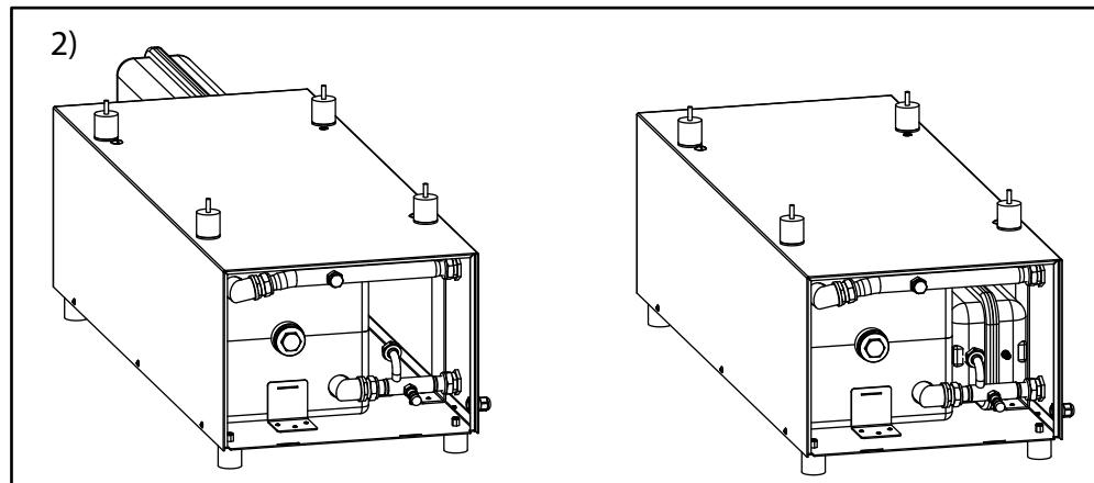
**NOTA:** in caso di utilizzo del prodotto con impianti di raffrescamento, utilizzare il rotolo di materiale isolante fornito col prodotto, per isolare le parti metalliche scoperte al fine di evitare la formazione di condensa all'interno del buffer.
